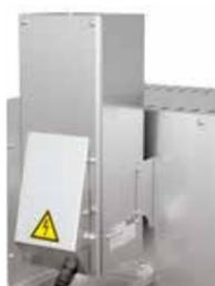
Catalizador con ventilador para depurar los componentes orgánicos del aire de escape. Los componentes orgánicos se queman catalíticamente a una temperatura aprox. de 600 °C, es decir, se separan en dióxido de carbono y vapor de agua. De este modo se eliminan en su mayor parte las molestias por malos olores. Los controladores B400 - P480 se puede activar el catalizador de forma automática (no en el modelo L(T) 15., L 1/12, LE 1/11, LE 2/11).\*
