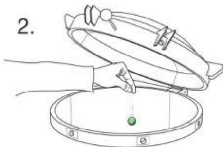
Coloque una cápsula en el fondo del autoclave o en un vaso de agua.
