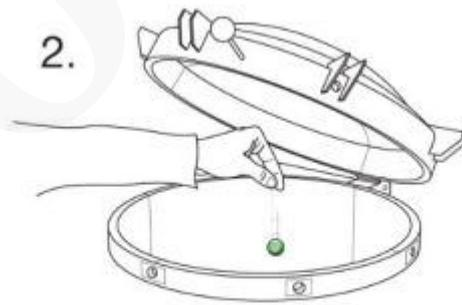
2. Coloque una cápsula en el fondo del autoclave o en un vaso de agua.
