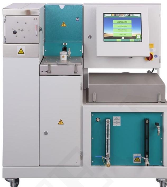
Analizador de asfalto 2011 de pantalla táctil, es controlado por computadora y operado a través del panel táctil para la extracción y determinación del ligante de materiales bituminosos dentro de un sistema cerrado que usa solventes no inflamables.
