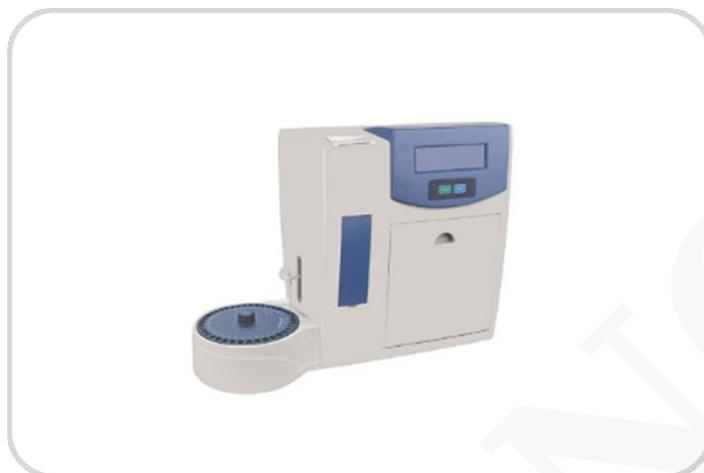
El instrumento es utilizado en hospitales para medir K +, Na +, Cl-, Ca<sup>2+</sup>, iones Li y TCO<sub>2</sub>, así como valores de pH, AG en muestras de sangre completa, suero, plasma, solución de orina diluida.
