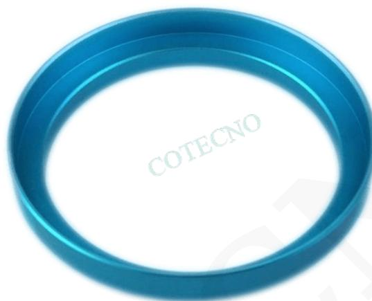
Anillo de contención para asegurar los bloques de reacción de un cuarto en placa calefactora
