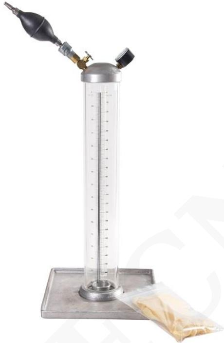
El aparato de densidad de globo se usa para determinar la densidad in situ de suelos compactados o firmemente unidos.
