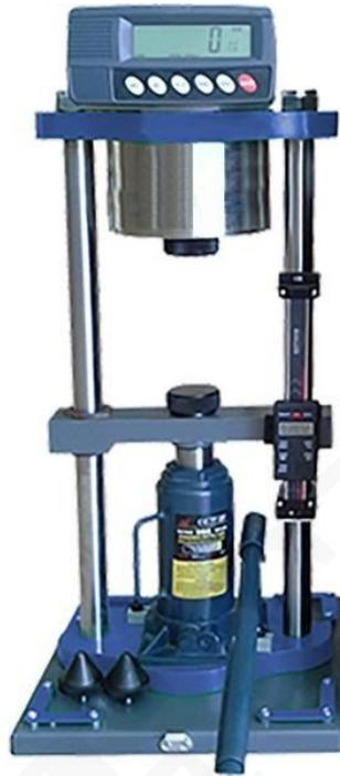
El aparato de prueba brasileño está diseñado para probar muestras de 50 mm de diámetro a 100 mm de diámetro con un espesor igual a la mitad del diámetro para la determinación de la resistencia a la tracción indirecta de las rocas.
