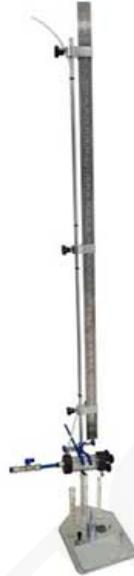
El aparato de prueba estenopeico se utiliza para evaluar la erosionabilidad de los suelos arcillosos haciendo fluir agua a través de un pequeño orificio que se perfora a través de la muestra compactada.
