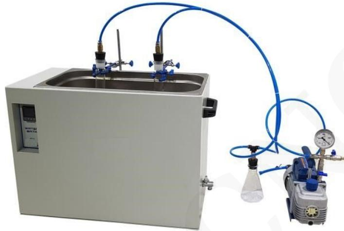
Se utiliza para la separación de disolvente de la solución aglutinante / disolvente y para determinar el contenido de aglutinante en una mezcla de agregado / betún.
