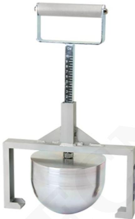
Se usa para determinar el trabajo del concreto fresco.
