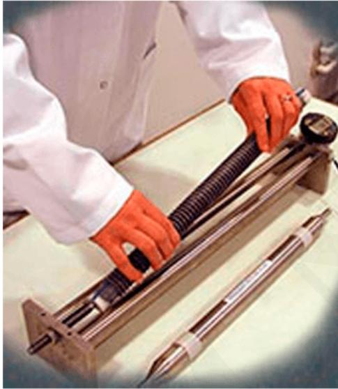
Mide la retracción autógena sin restricción de especímenes fabricados con pasta de cemento o mortero bajo condiciones de curado hermético (ASTM C1698, Método de prueba para la deformación autógena de pastas de cemento y morteros)
