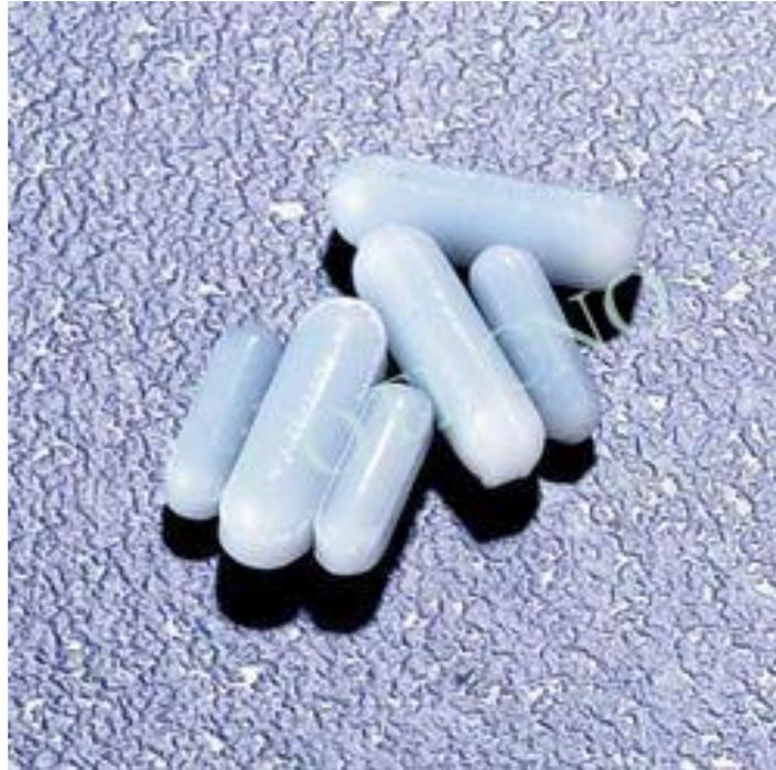
Barra de agitación magnética SCIOLOGEX recubierta de PTFE, redonda sin anillo de pivote 13 x 8 mm
