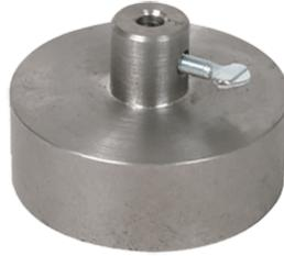
Para uso con morteros de mampostería para determinar la vida útil de la placa y la consistencia inicial. El método puede usarse como base para la aceptación de morteros. Disco de acero inoxidable, 2.70" (68.58 mm) de diámetro. Se puede usar con los Penetrómetros H-4134 o H-4132.
