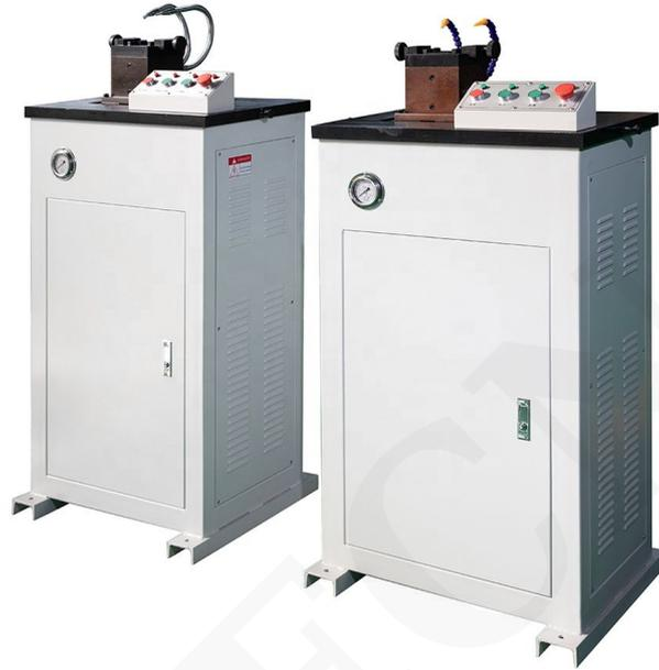
Diseñado para proporcionar las muestras utilizadas en las tareas de pruebas de impacto. Tanto el tipo manual como el hidráulico están disponibles para cortar la muesca según las normas "V" ASTM E23, ISO148, "U" DIN 50115 y ISO83 "Charpy Notch Impact Test Method for Metal Material" en la muestra por una sola vez. Al mismo tiempo, tiene ventajas de alta precisión, larga vida útil, bajo nivel de ruido y apariencia concisa, etc.
