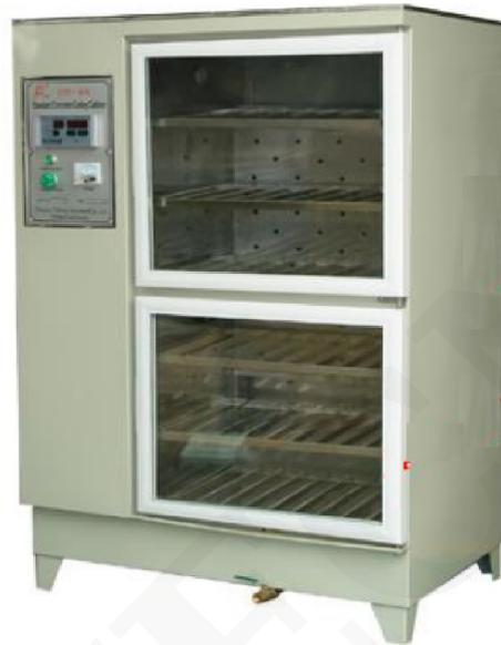
Las funciones incluyen calefacción, refrigeración, pulverización control de temperatura y humedad.
