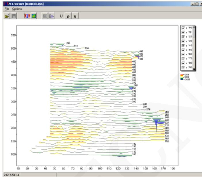
El software ZCGViewer está diseñado para el cálculo y visualización de gráficos de resistividad aparente obtenidos con cualquier sistema de perfilado electromagnético. El sistema de medición siguiente: la línea de bucle-línea, la línea es un bucle, la línea de bucle.
