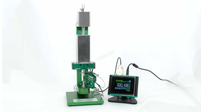
El calibrador de muy alta resolución de Epsilon presenta una resolución de 20 nanómetros (0.8 microinches) y tiene un rango de medición de 50 mm (2 pulgadas). El calibrador 3590VHR cumple con los requisitos de precisión y resolución para ASTM E83 Clase B-1 para extensómetros con longitudes de calibre  $\geq 6$  mm, y cumple con ISO 9513 Clase 0,5, ambos en todo el rango de medición del calibrador. El 3590VHR incluye una pantalla táctil de lectura digital y software para PC.
