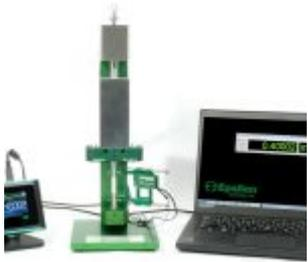
Calibrador modelo 3590VHR con pantalla táctil y software (computadora opcional)
