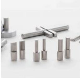
Adaptadores de fijación de extensómetro
