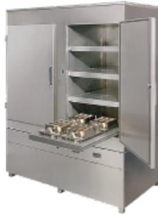
Estos gabinetes de humedad verticales han sido diseñados específicamente para el curado y almacenamiento de prismas y cubos de mortero en moldes de 3 unidades. Cuentan con una construcción duradera de acero inoxidable con estantes para muestras duraderos que resisten la carga y descarga de moldes.
