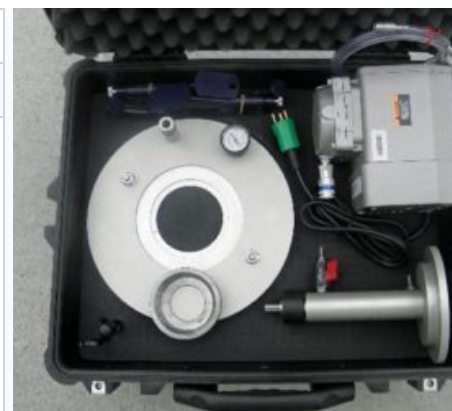
B-10000 DSV-Kit: Para cepillar superficies, unir el disco y fijar el equipo de perforación para producir el núcleo sin anclaje.
