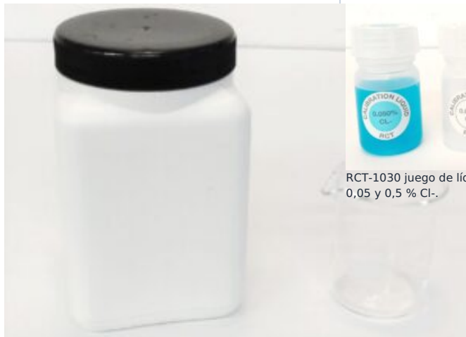
Recipiente y vaso para mezclar RCT -1032. Para muestras de hormigón fresco.
