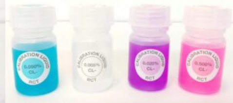
RCT-1030 juego de líquidos de calibración, 0,005, 0,020, 0,05 y 0,5 % Cl-.
