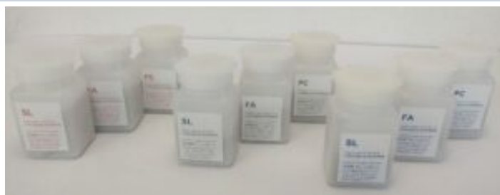
RCT-1027 Polvos de Referencia Certificados 9 frascos, cada uno con 70 gramos de polvo de concreto, con cantidades conocidas de cloruros y titulado según AASHTO T-260.
