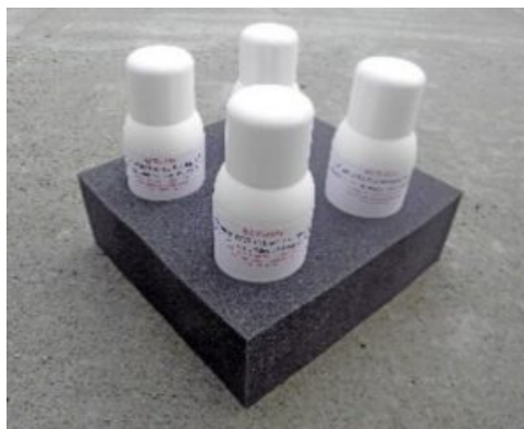
Viales RCT-1031, juego de 4, para probar concreto fresco.
