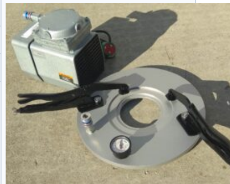
Placa de succión opcional con bomba de vacío.
