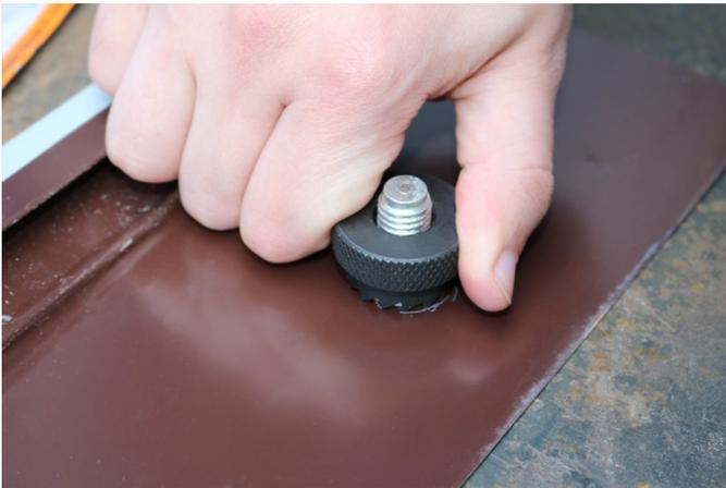
Para determinar la adherencia del revestimiento, utilizando el probador de adherencia por tracción NOVOTEST AC-1 requiere:
