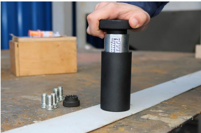
El dispositivo es muy fácil de usar, universal, ya que se puede utilizar con casi cualquier revestimiento, tiene un diseño fiable, que prácticamente no tiene limitaciones en la vida útil del producto, y preciso como un dispositivo que mide la adherencia en términos numéricos.
