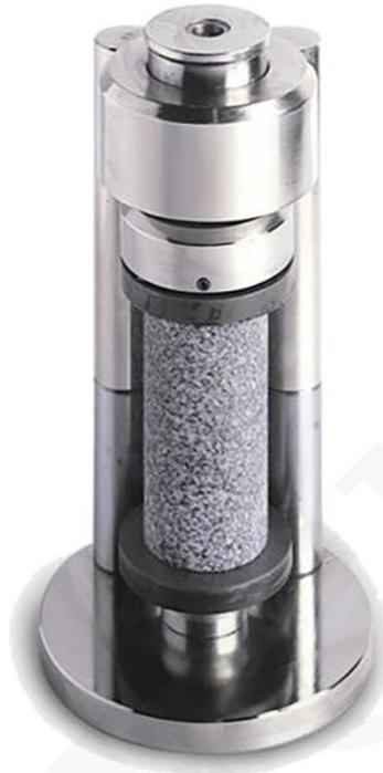
El conjunto de plantilla se utiliza para pruebas de resistencia a la compresión uniaxial de muestras de núcleos de roca con  $\varnothing$  50 a 55 mm y 100 a 110 mm de altura y consta de un marco de dos columnas con una placa superior con asiento esférico que se mueve verticalmente sostenido por un resorte.
