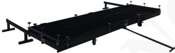
El conjunto de prueba de la bandeja de depósito se utiliza para determinar la uniformidad transversal de la distribución del aglutinante rociado
