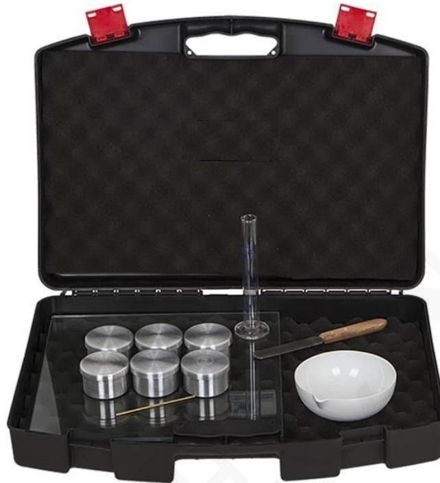
El límite de plástico determina el contenido de humedad más bajo de un suelo, por el cual una muestra se puede enrollar en hilos de  $\varnothing$  3 mm sin romperla, ya sea longitudinalmente o transversalmente.
