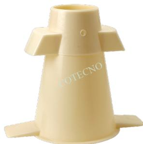
El cono de asentamiento de plástico liviano no se abollará ni se oxidará y se puede limpiar con un baño de ácido. Formado con asas y patas para usar con la placa base H-3636. 8 "(203 mm) de diámetro en la base, 4" (102 mm) de diámetro en la parte superior y 12 "(305 mm) de alto.
