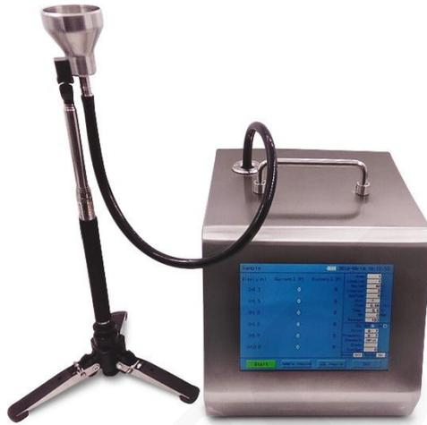
El contador de partículas láser se utiliza para medir el volumen de aire dentro del ambiente limpio de partículas de polvo en tamaño y número, se puede detectar directamente el área de limpieza clase A, el área de clase B ambiente limpio. contador de partículas láser que utiliza una fuente de luz laser semiconductor, una gran pantalla táctil, tamaño pequeño, peso ligero, alta precisión de detección
