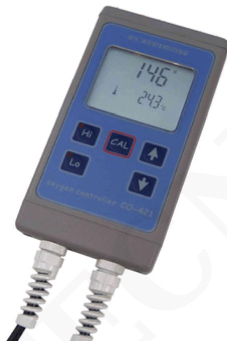
El CO-421 es un dispositivo estacionario utilizado para mediciones continuas de la concentración del oxígeno en agua limpia o aguas residuales, en el aire y la temperatura. Además, permite la regulación de la concentración de oxígeno con el uso de relés (máximo y mínimo). La lectura puede mostrarse en% del oxígeno concentración o en mg / l (la versión adecuada del dispositivo debe especificarse en el pedido).
