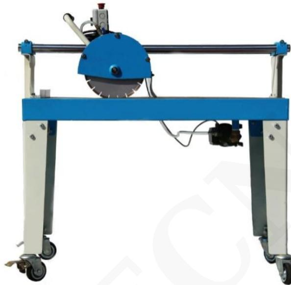
La máquina de corte de núcleo Manuel se utiliza principalmente para cortar muestras de roca, hormigón y núcleo de varios tamaños y para obtener dos medios cilindros a partir de muestras de núcleo.
