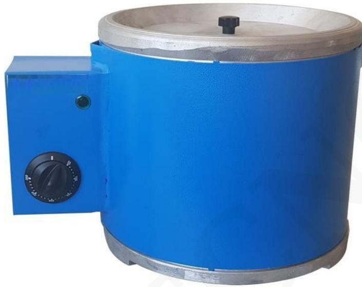
El aparato consiste en un contenedor de fundición de aluminio de 3,5lt de capacidad, cubierto por una resistencia especial de acero,
