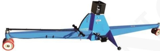
Dispositivo de haz móvil de 3 metros de largo se utiliza para comprobar si hay irregularidades en las superficies de carreteras de hormigón y bituminosas. Una unidad de detección que comprende una rueda conectada a un indicador proporciona un aumento de 4: 1.
