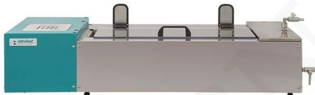
Ductilómetro de 400 mm para la determinación del restablecimiento elástico del betún. Carcasa de acero inoxidable con baño de agua aislado con tapa y motor paso a paso que proporciona un rango de velocidad variable de 1 a 50 mm / min. Con sistema de medición de desplazamiento digital. Se pueden probar hasta 4 muestras simultáneamente.
