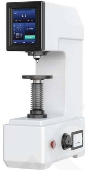
Proceso de ensayo automático, poner la muestra, pulsar el botón "Start" para obtener el valor de dureza de cada muestra
