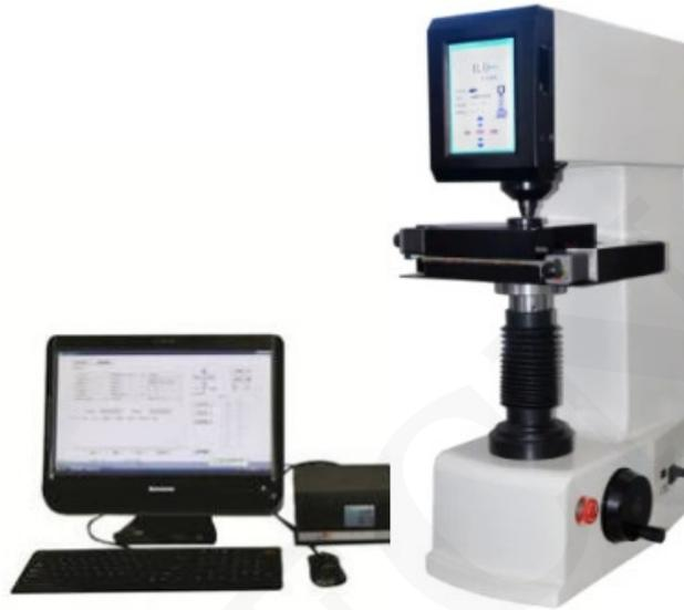
Proceso de ensayo automático, poner la muestra, pulsar el botón "Start" para obtener el valor de dureza de cada muestra
