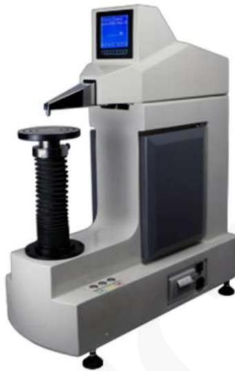
La fuerza de prueba se aplica a través de una unidad de control de bucle cerrado con una célula de carga, un motor de corriente continua y una unidad electrónica de medición y unidad de control sustituyen a los tradicionales pesos muertos. El resultado es mediciones altamente precisas en todas las cargas de prueba hasta el 0,5%.
