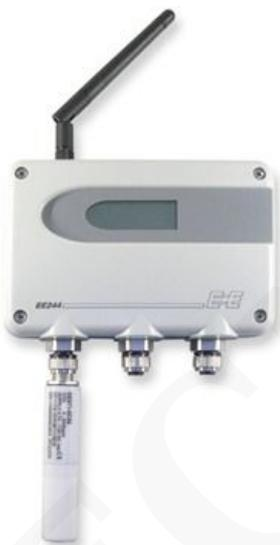
El transmisor inalámbrico modular EE244 se basa en el protocolo IEEE 802.15.4 con una frecuencia de transmisión de 2.4 GHz y mide hasta tres cantidades físicas: humedad relativa, temperatura y CO2.
