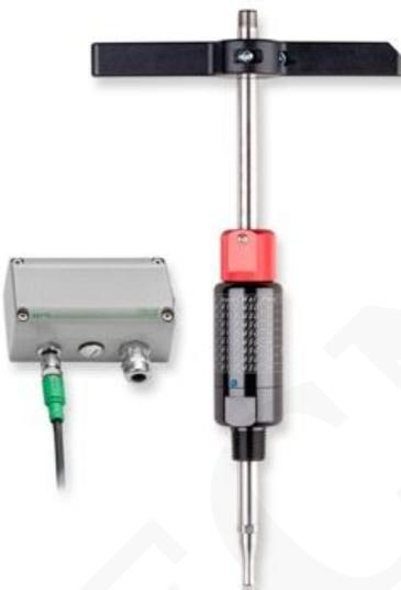
Es un medidor de flujo másico térmico dedicado a monitorear aire comprimido, nitrógeno, CO<sub>2</sub> u otros gases no corrosivos y no inflamables. Puede emplearse en tuberías de DN50 a DN700 (2 "a 28") y hasta 16 bar (232 psi). El medidor de flujo EE776 estableció nuevos estándares en términos de seguridad y fácil montaje. La protección antirretorno patentada combina tres funciones en un solo dispositivo
