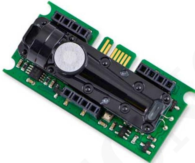
El módulo digital EE894 mide el dióxido de carbono (CO<sub>2</sub>), la humedad relativa (RH), la temperatura (T) y la presión ambiental (p). La compensación de temperatura y presión garantiza una alta precisión de medición de CO<sub>2</sub> en condiciones ambientales cambiantes. La dimensión muy pequeña y la interfaz I<sup>2</sup>C o E2 facilitan el diseño.
