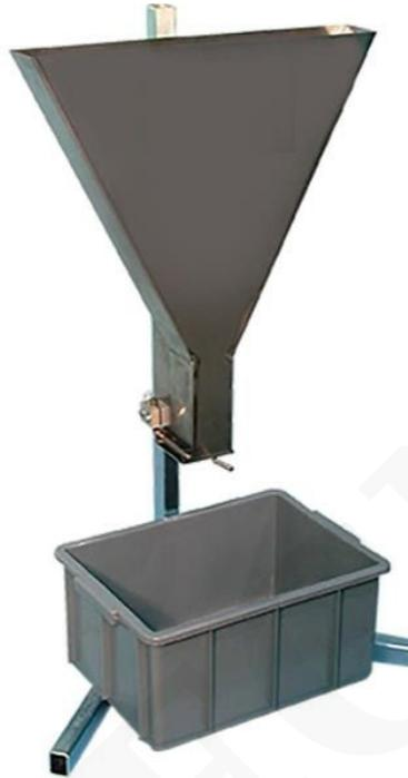
El aparato se usa para evaluar la resistencia a la segregación del concreto autocompactante recién mezclado mediante la observación de la velocidad de flujo debido a la diferencia del período restante de las muestras en el embudo.
