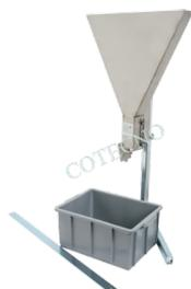
Diseñado para evaluar la resistencia a la segregación del concreto autocompactable a través de la velocidad de flujo de un embudo. Aplicable al concreto con agregados de 1 "(25 mm) de tamaño máximo Construcción de acero inoxidable con capacidad de 10 L. El borde superior es liso y reforzado y el orificio de salida está equipado con una válvula sellable. Incluye caja de polietileno para recoger la descarga y 36" (914 mm ) borde recto largo para nivelar el concreto antes de la prueba.
