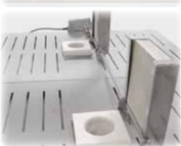
Válvula de salida de aire con control motorizado para acelerar el enfriamiento del horno tras concluir la cocción
