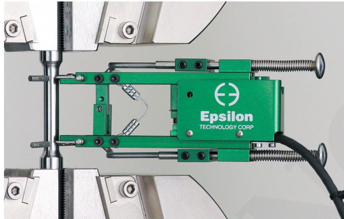
Estos extensómetros están diseñados para probar una amplia gama de materiales, incluidos metales, plásticos, compuestos y cerámicas. Todos realizarán mediciones de tensión y de compresión. El diseño de doble flexión los hace muy resistentes e insensibles a las vibraciones, lo que permite una operación de mayor frecuencia.
