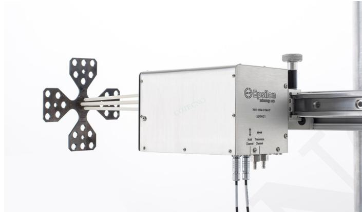
Los extensómetros modelo 7651 miden las deformaciones combinadas en el plano en muestras cruciformes planas probadas en máquinas capaces de carga axial simultánea X e Y (perpendicular) y en muestras planas estándar probadas en tensión pura. Todos los modelos tienen capacidad de desplazamiento bidireccional en ambos ejes y se pueden usar para pruebas de fatiga controladas por tensión en condiciones de carga y tensión totalmente invertidas a frecuencias de hasta 10 Hz.
