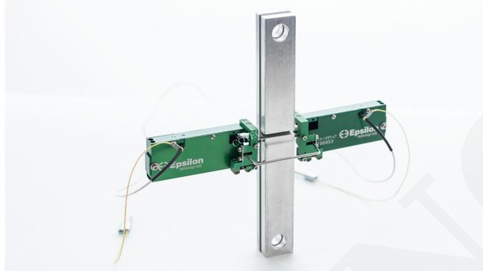
Diseñado específicamente para realizar pruebas de acuerdo con ASTM D5656, Método de prueba estándar para juntas de cizallamiento de metal grueso y adherente para la determinación del comportamiento de tensión y deformación de los adhesivos en cizallamiento por carga de tensión. La deformación se mide en lados opuestos de la muestra de prueba y la salida es un promedio de las dos lecturas.
