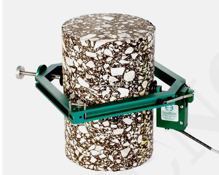
Autoportantes en la muestra de prueba, estos extensómetros funcionarán en muestras de diámetro de tamaño estándar, pero hay configuraciones especiales disponibles a pedido. Están diseñados para su uso en pruebas de la relación de Poisson y para aplicaciones donde se requieren mediciones diametrales precisas con baja tensión.
