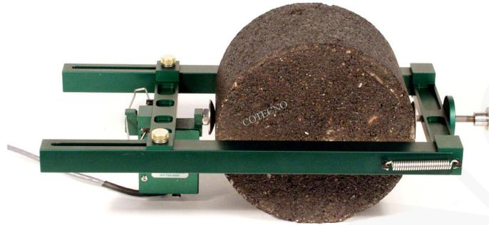
Diseñado para satisfacer muchas de las necesidades de prueba de muestras de núcleos de asfalto en diámetros de 100 mm y 150 mm (4 y 6 pulgadas). Cumple con los requisitos del método de prueba para la medición de deformación desarrollado bajo el programa SHRP de las autopistas federales de EE. UU.
