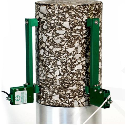
Estos extensómetros se montan típicamente como dos módulos axiales con salidas independientes capaces de medir deformaciones de muestras en dos ubicaciones, pero se pueden montar como una sola unidad o hasta cuatro en una muestra. Se acoplan rápidamente en los puntos de calibración montados según los requisitos de prueba.
