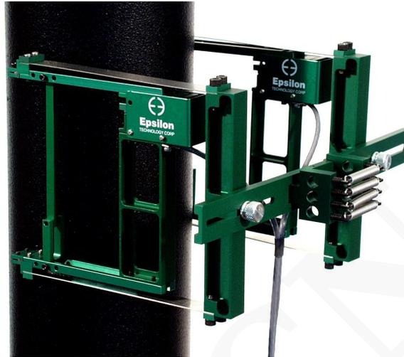
Diseñado principalmente para pruebas de resistencia a la compresión en roca, concreto y otras muestras de compresión grandes, este modelo mide la tensión axial en lados opuestos de la muestra de prueba, y la salida es un promedio de las dos lecturas. Están disponibles longitudes de calibre de 25 a 200 mm (1 a 8 pulgadas) y rangos de medición de 1.2 a 6 mm (0.050 a 0.250 pulgadas).
