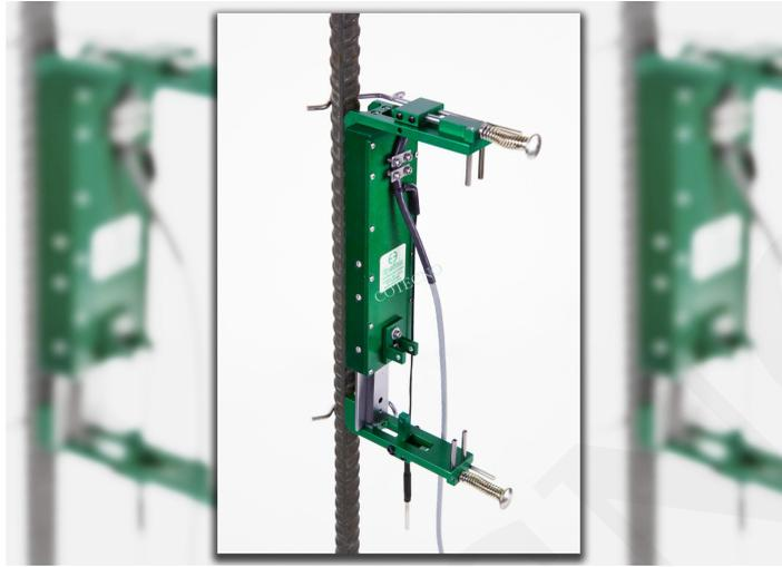
Este modelo está disponible en longitudes de calibre de 50 mm (2 pulgadas) y mayores, con rangos de medición de hasta 100 mm (4 pulgadas). El diseño único se separa en dos mitades y el extensómetro puede dejarse encendido por falla de la muestra. Estos extensómetros son ampliamente utilizados donde se requieren muestras largas. Son ideales para probar barras de acero, uniones de soldadura y materiales de alambre.
